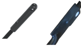
Fig. 8: sonde d'humidité (à gauche) et sonde VOC (à droite)
